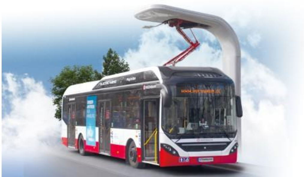
Abbildung 31: Schnelllade-Docking-Station mit Ladepantograph [ST 2019]
